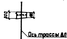
Схема установки стойки опоры
