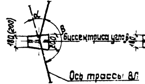
Схема установки стоек опоры
